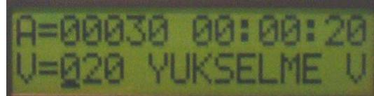
3- ÇALIŞMA : Programlanan voltajda çalışma süresidir. Yükselme süresi bitiminde devreye girer ve ayarlanan süre bitiminde transformator otomatik olarak stop eder.
