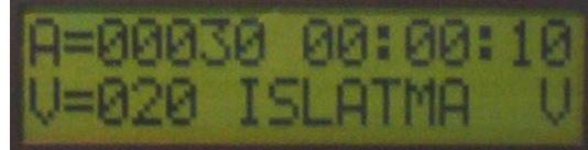
2- YÜKSELME : Transformator, voltaj hanesine yazılan voltaj değerine Yükselme süresi boyunca artarak ulaşır. Örneğin, voltaj değeri 10 Volt ve Yükselme süresi olarak 20 saniye yazılmış ise, ISLATMA süresi bitiminde gerilim her 1 saniyede 0,5 Volt yükselterek 20 saniyede 10 Volt'a ulaşacaktır. Yükselme Süresi' ni kullanmak istemiyorsanız 00:00:00 girin.
